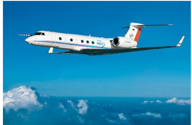
Das DLR-Forschungsflugzeug HALO kann Messungen in der Wetterschicht der Atmosphäre, also in der Troposphäre, und sogar in der Stratosphäre durchführen. Foto: DLR
